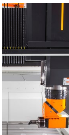
2osá univerzální hlava s úpravou pro soustružení
