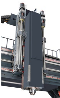
Smykadlo – 4 lineární vedení a 2 kuličkové šrouby
