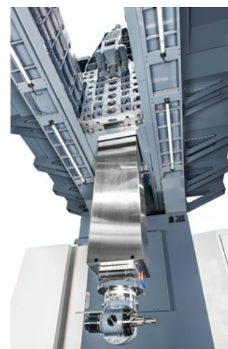
Dvojitý příčnick a uložení smykadla „box in box“
