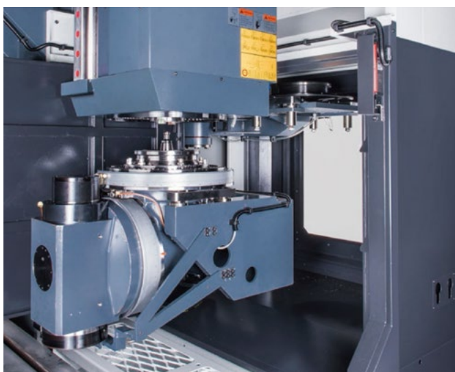
Pick-up pro automatickou výměnu 1 hlavy
