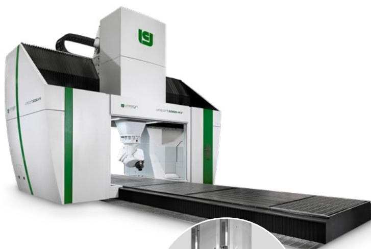
2osá plynule řízená hlava s výkonem až 73 kW
