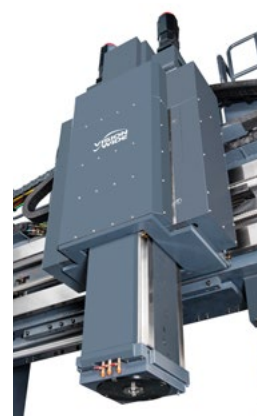
Uzavřený typ smykadla – 8 kluzných vedení a 2 kuličkové šrouby
