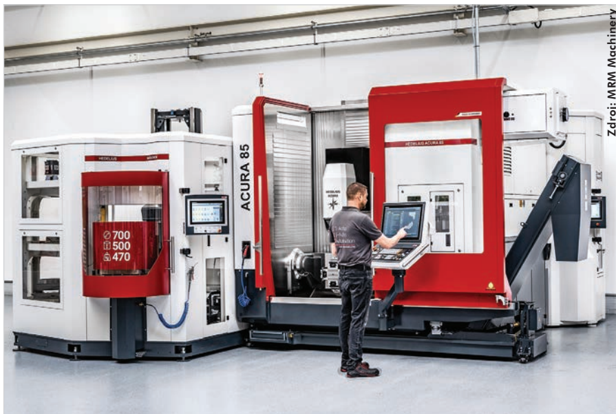
Obráběcí centrum Acura 85 Marathon se systémem Marathon SR518 je navrženo pro flexibilní automatizaci velkých a těžkých kusových dílů, ale i malých až středních dávek.
