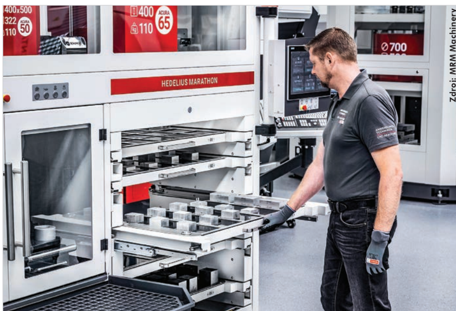
Marathon RZ430 kombinuje manipulaci s paletami a obrobky v hybridním automatizačním řešení pro řadu obráběcích center Acura.
