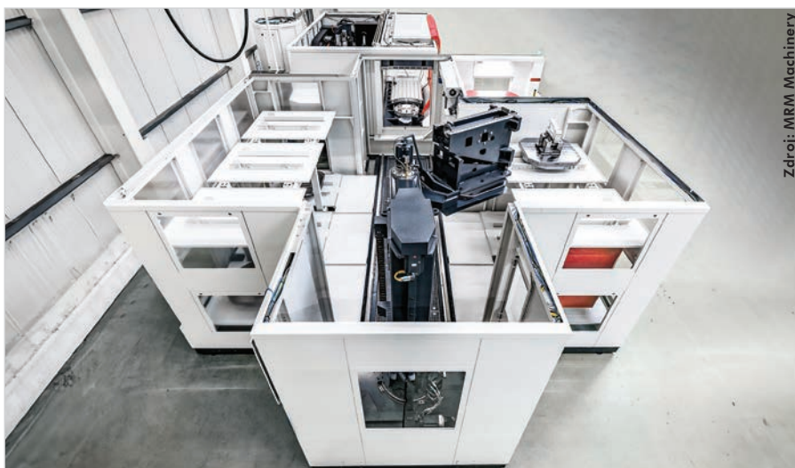
Automatizační systém Marathon LR810 nabízí 10 paletových míst pro palety o rozměru 800 x 800 mm.
