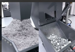
+ lis na třísky separuje chladicí a mazací kapalinu a snižuje objem třísek
