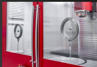
+ kontrola procesu obrábění pomocí otočného okna Visiport s ofukem
