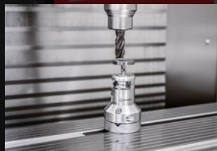
+ dotyková sonda ke kontrole a měření nástroje
