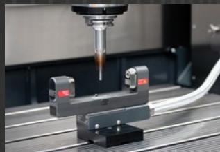
+ laserová sonda ke kontrole a měření nástroje
