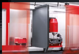
+ dělicí příčka pracovního prostoru + automatický posuv dveří
