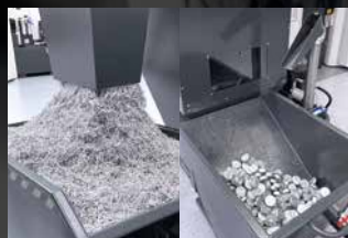
+ Lis na třísky separuje chladicí a mazací kapalinu a stlačuje třísky
