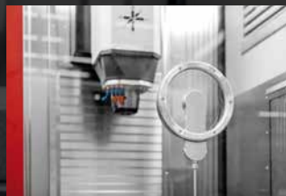
+ Kontrola procesu obrábění pomocí otočného okna Visiport s ofukem
