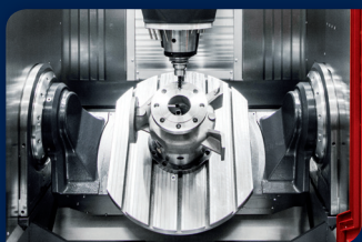
Po obou stranách umístěný hydraulicky upnutý otočný naklápací stůl
