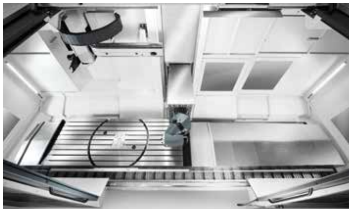
Ložová frézka KT-3200-R s integrovaným otočným stolem, detail pracovního prostoru
