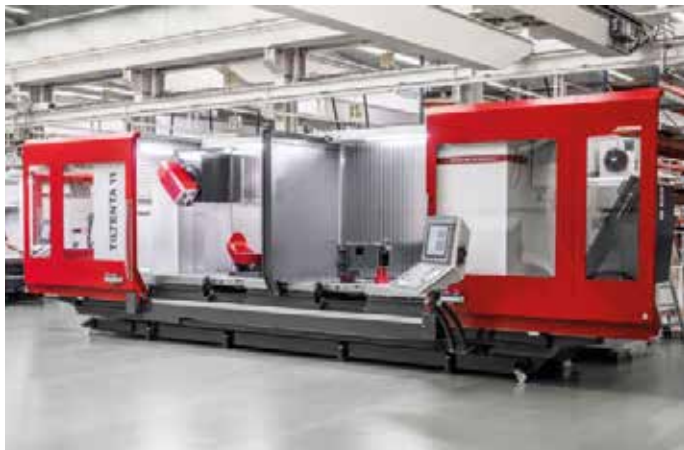
Obráběcí centrum TILTENTA 11 s rozděleným pracovním prostorem
