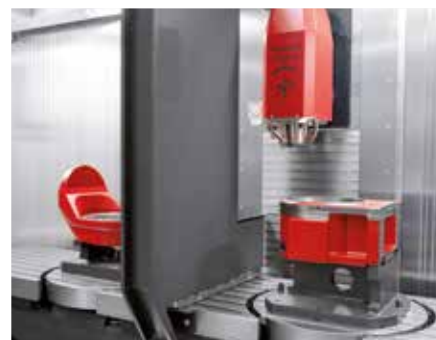
5osé obráběcí centrum s pojízdným stojanem: čelní obrábění (vlevo), obrábění v rozděleném pracovním prostoru (vpravo)
