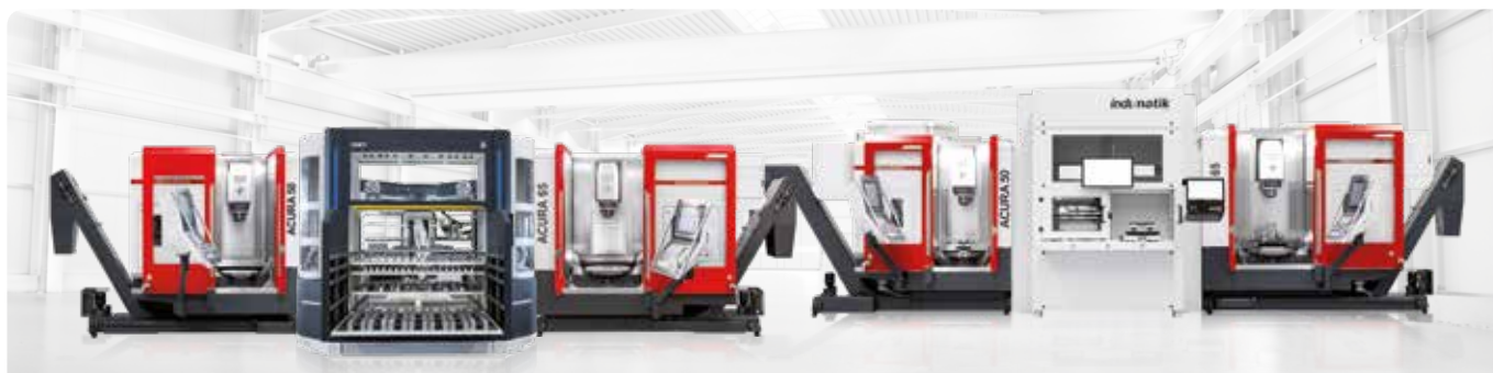
Koncepce „Twiner“: dvě 5osá obráběcí centra v řadě s robotickou buňkou (vlevo) nebo manipulace s paletami (vpravo)
