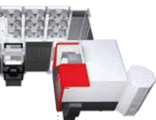
EROWA ERD 150/250/500 Lineární robot, počet palet individuální Upínací plocha 400 x 400 mm/320 x 320 mm/Ø 210 mm Manipulační hmotnost 150 kg/250 kg/500 kg
