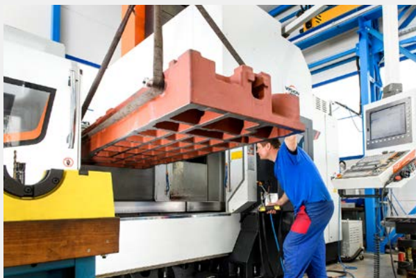
Obrábění stojanu na lisovací nástroje
