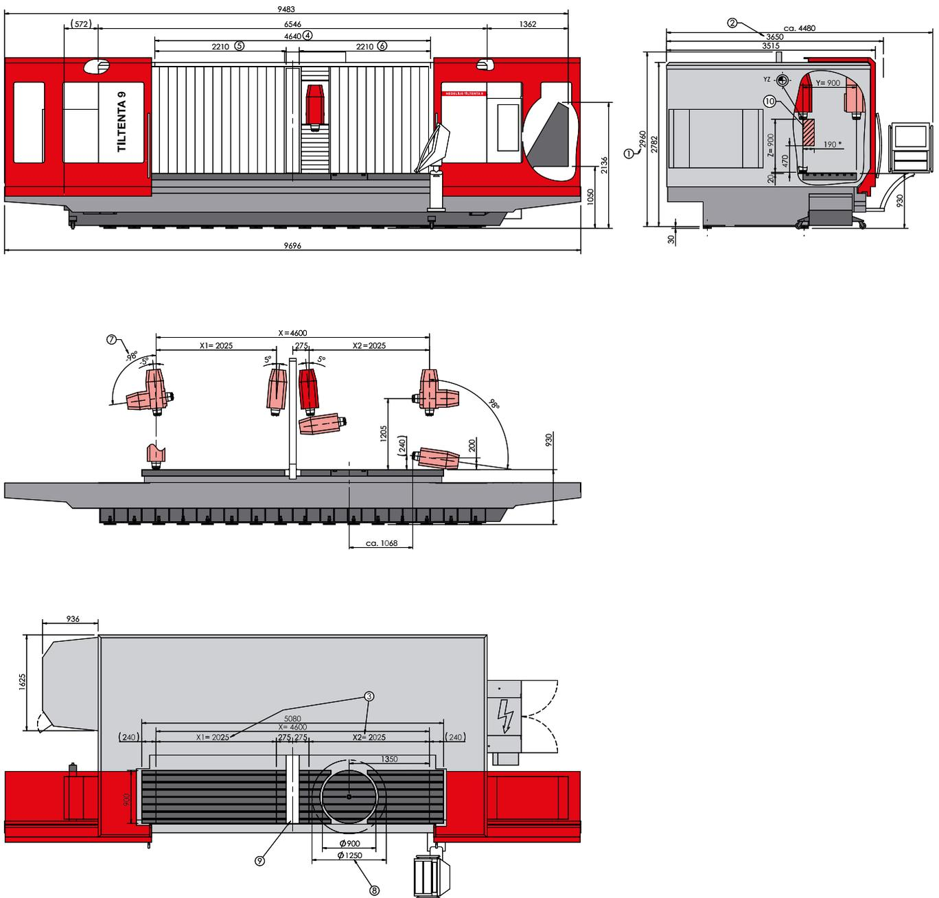
Zeichnungen unverbindlich. Maße können sich ändern und dienen als Richtwert. [Illustrations are not binding. Dimensions are subject to change and serve for orientation purpose.] Abbildung zeigt die TILTENTA 9 mit dem MAGNUM-Werkzeugmagazin für 60 Werkzeuge und mit einem Kratzbandspäneförderer. [Figure shows the TILTENTA 9 with MAGNUM tool magazine for 60 tools and with scraper belt chip conveyor.]
