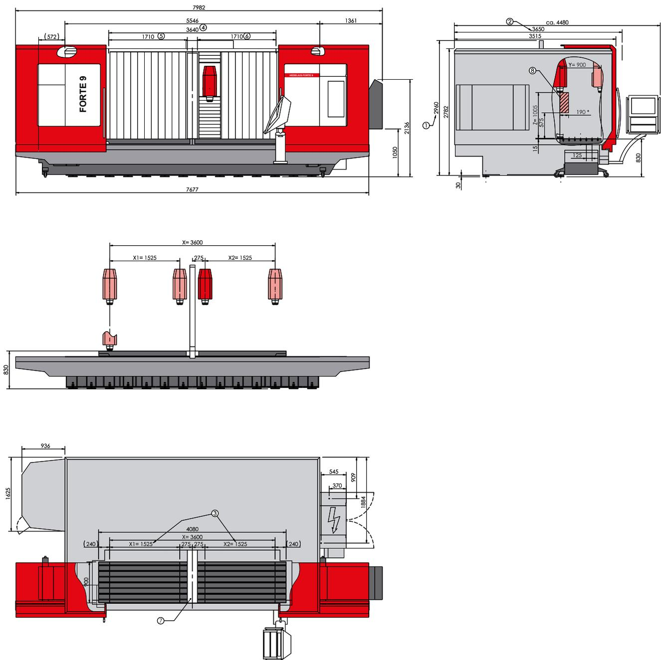
Zeichnungen unverbindlich. Maße können sich ändern und dienen als Richtwert. [Illustrations are not binding. Dimensions are subject to change and serve for orientation purpose.] Abbildung zeigt die FORTE mit dem MAGNUM-Werkzeugmagazin für 60 Werkzeuge und mit einem Kratzbandspäneförderer. [Figure shows the FORTE with MAGNUM tool magazine for 60 tools and with scraper belt chip conveyor.]
