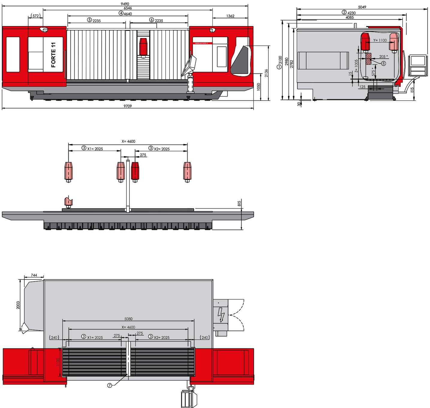
Zeichnungen unverbindlich. Maße können sich ändern und dienen als Richtwert. [Illustrations are not binding. Dimensions are subject to change and serve for orientation purpose.] Abbildung zeigt die FORTE 11 mit dem Magnum-Werkzeugmagazin für 65 Werkzeuge und mit einem Kratzbandspäneförderer. [Figure shows the FORTE 11 with Magnum tool magazine for 65 tools and with scraper belt chip conveyor.]
