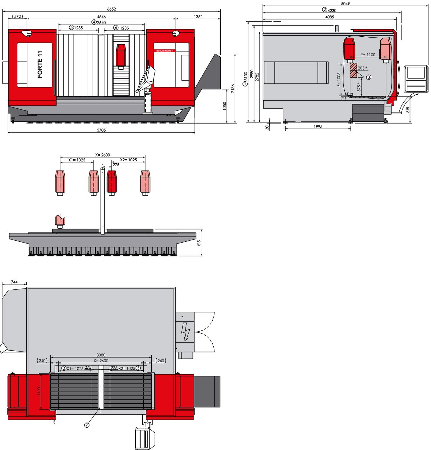
Zeichnungen unverbindlich. Maße können sich ändern und dienen als Richtwert. [Illustrations are not binding. Dimensions are subject to change and serve for orientation purpose.] Abbildung zeigt die FORTE 11 mit dem Magnum-Werkzeugmagazin für 65 Werkzeuge und mit einem Kratzbandspäneförderer. [Figure shows the FORTE 11 with Magnum tool magazine for 65 tools and with scraper belt chip conveyor.]
