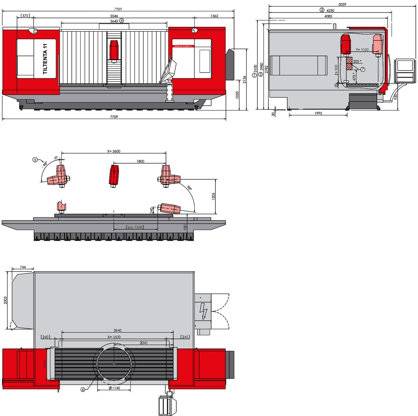
Zeichnungen unverbindlich. Maße können sich ändern und dienen als Richtwert. [Illustrations are not binding. Dimensions are subject to change and serve for orientation purpose.] Abbildung zeigt die TILTENTA 11 mit dem Magnum-Werkzeugmagazin für 65 Werkzeuge und mit einem Kratzbandspäneförderer. [Figure shows the TILTENTA 11 with magnum tool magazine for 65 tools and with scraper belt chip conveyor.]
