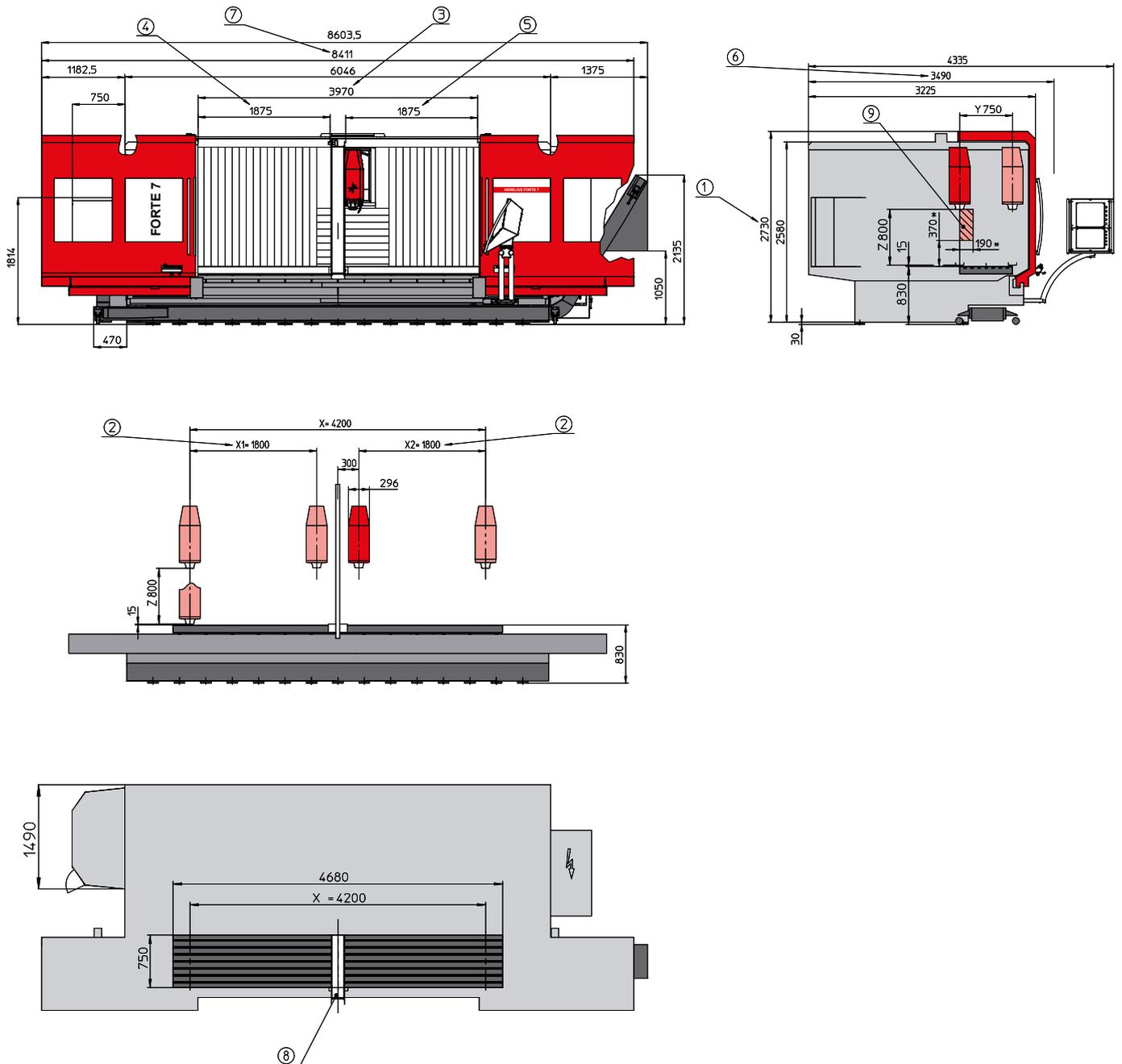
Zeichnungen unverbindlich. Maße können sich ändern und dienen als Richtwert. [Illustrations are not binding. Dimensions are subject to change and serve for orientation purpose.] Abbildung zeigt die FORTE mit dem Magnum-Werkzeugmagazin für 50 Werkzeuge und mit einem Kratzbandspäneförderer. [Figure shows the FORTE with magnum tool magazine for 50 tools and with scraper belt chip conveyor.]
