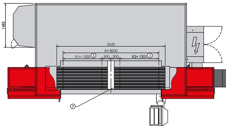
Zeichnungen unverbindlich. Maße können sich ändern und dienen als Richtwert. [Illustrations are not binding. Dimensions are subject to change and serve for orientation purpose.] Abbildung zeigt die FORTE mit dem Magnum-Werkzeugmagazin für 50 Werkzeuge und mit einem Kratzbandspäneförderer. [Figure shows the FORTE with magnum tool magazine for 50 tools and with scraper belt chip conveyor.]
