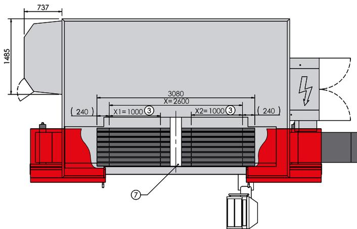
Zeichnungen unverbindlich. Maße können sich ändern und dienen als Richtwert. [Illustrations are not binding. Dimensions are subject to change and serve for orientation purpose.] Abbildung zeigt die FORTE mit dem Magnum-Werkzeugmagazin für 50 Werkzeuge und mit einem Kratzbandspäneförderer. [Figure shows the FORTE with magnum tool magazine for 50 tools and with scraper belt chip conveyor.]
