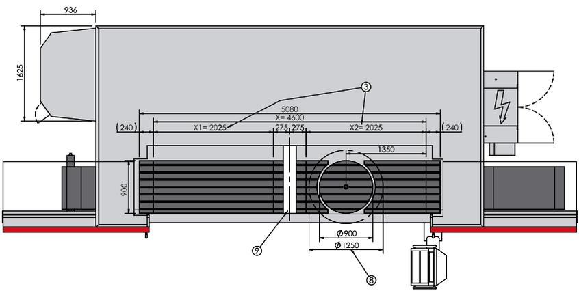
Zeichnungen unverbindlich. Maße können sich ändern und dienen als Richtwert. [Illustrations are not binding. Dimensions are subject to change and serve for orientation purpose.] Abbildung zeigt die TILTENTA 9 mit dem Magnum-Werkzeugmagazin für 60 Werkzeuge und mit einem Kratzbandspäneförderer. [Figure shows the TILTENTA 9 with magnum tool magazine for 60 tools and with scraper belt chip conveyor.]
