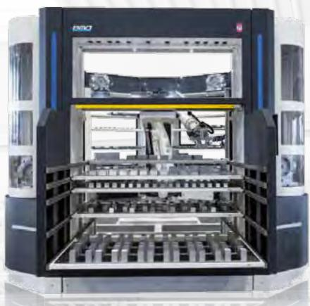
Das Modell Titanium verfügt über bis zu 35 Palettenspeicherplätze sowie zwei Palettenrüststationen, um kombiniert Werkstücke oder Paletten abzuarbeiten. Damit auch schwere Werkstücke auf Paletten abgearbeitet werden können, stehen Roboter mit 180 kg oder 500 kg zur Auswahl. Aufgrund der Werkzeugstandzeit werden derzeit überwiegend Aluminium- und Kunststoffwerkstücke mittels Roboter automatisiert.
