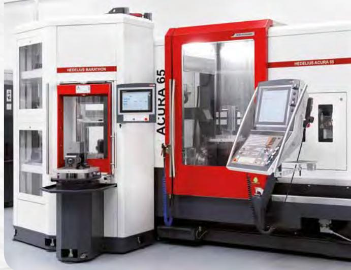
Zur Optimierung des Fertigungsprozesses rücken die Rüst- und Spannzeiten immer mehr in den Fokus der Produktionsverantwortlichen. In der Vergangenheit haben sich daher zur Rüstoptimierung bereits große Werkzeugmagazine und Nullpunktspanntechnik in vielen Betrieben etabliert. Mit der Entwicklung des MARATHON Multi-Palettenspeichers P422 vollzieht HEDELIUS nun den nächsten Schritt, die Spindellaufzeit der Maschine und damit die Produktivität weiter zu steigern.
