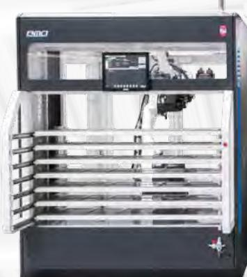
Die Werkstücke werden aus Rasterschubladen durch einen 6-Achs-roboter entnommen und in die Maschine eingelegt. Um sehr flexibel auch auf kleine Losgrößen reagieren zu können und die mannlose Laufzeit der Anlage zu erhöhen, verfügt die Platinum-Automationslösung zudem über acht Palettenplätze zum Vorhalten der Spannvorrichtungen.
