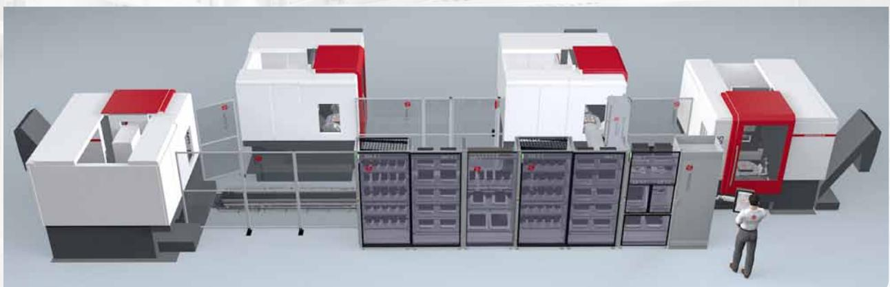
An die HEDELIUS ACURA Baureihe können zahlreiche Automationssysteme angebunden werden wie z. B. Multi-Palettenspeicheranlagen vom Typ Indumatik Light oder Erowa Leonardo bis hin zu Linearsystemen für die Verkettung mehrerer Maschinen. [Numerous automation systems can be connected to the HEDELIUS ACURA series, e.g. multi-pallet storage systems of the type Indumatik Light or Erowa Leonardo, up to linear systems for the chaining of several machines.]
