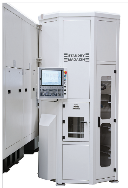
Stroj lze dovybavit o záložní zásobník pro 190 nástrojů vč. čisticí stanice nástrojů.
