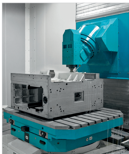
Verze HV-HVA disponuje vřetenem v horizontální nebo vertikální poloze.
