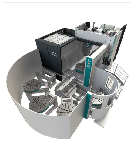
Pro zvýšení produktivity je možné stroj doplnit paletizací – na obrázku je příklad s 5 paletami.
