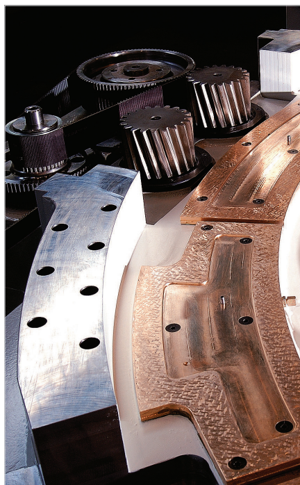
Hybridní otočné stoly mají patentované dvojí uložení – na hydrostatice pro standardní obrábění a na ložisku pro vertikální soustružení.
