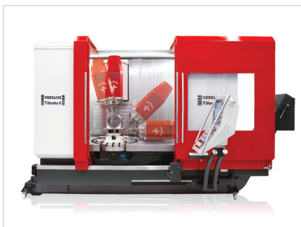
Tiltenta 6 Single je vertikální 5osé obráběcí centrum vyráběné německou společností Hedelius Maschinenfabrik.
