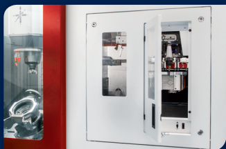
Zásobník na 65 nástrojů přístupný z přední části stroje
