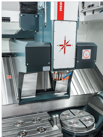
Stroje Hedelius mohou být doplněny o upínací systém s nulovým bodem Garant ZeroClamp.
