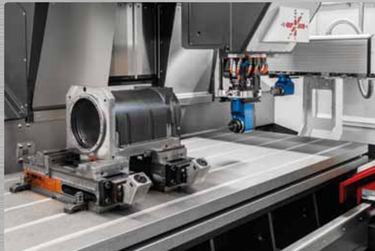
Winkelfräsköpfe für die Stirnseitenbearbeitung. [Angle milling heads for end face machining.]
