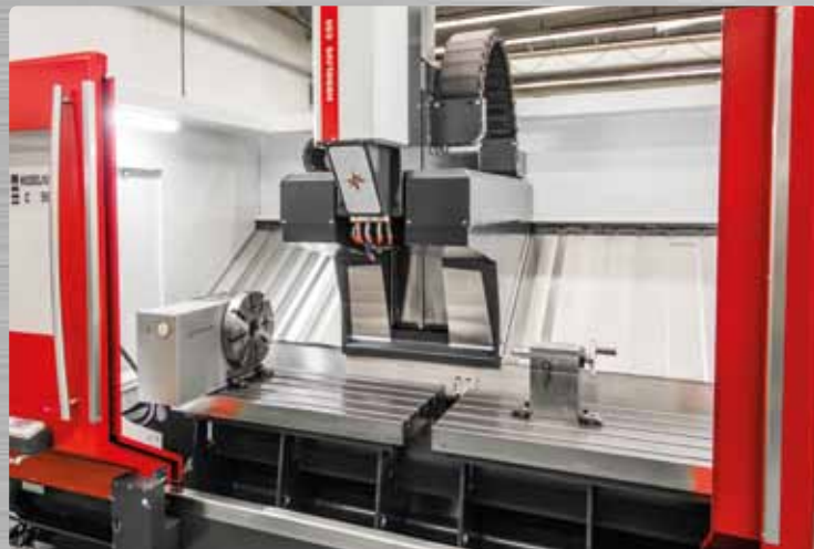
Der Arbeitsraum kann mit NC-Rundtischen ausgestattet werden. [The workspace can be equipped with NC rotary tables.]
