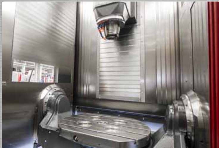
Automatische Beladung von der linken Maschinenseite. [Automatic loading from the left machine side.]
