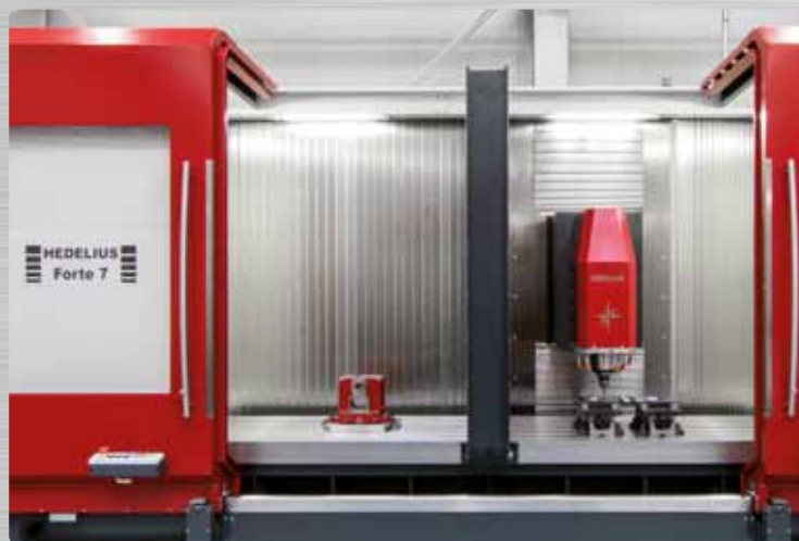
Zwei Arbeitsräume sind für den Pendelbetrieb möglich. [Two 3-axis workspaces are available for pendulum operations.]
