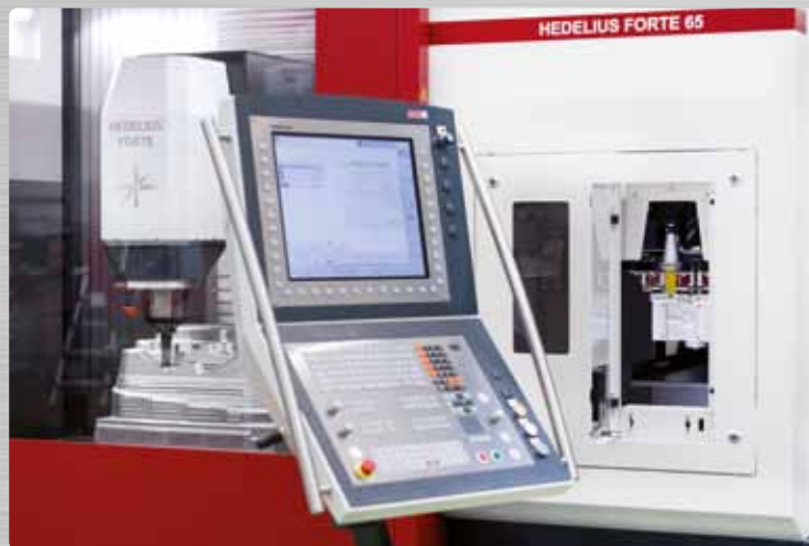
65-fach Werkzeugmagazin von vorne bedienbar. [65-tool magazine operated from the front.]
