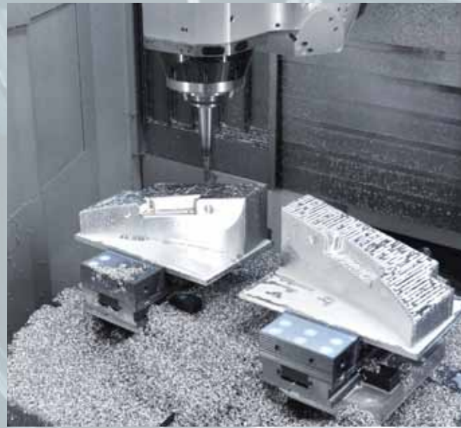
Die insert, finishing 18.000 rpm
