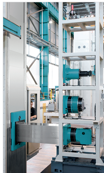
Obr. 5. Pama vyvíjí a vyrábí výměnné hlavy sama, má jich na 120.
