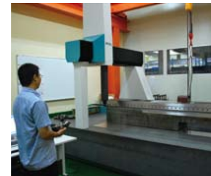
a. CMM inspection
